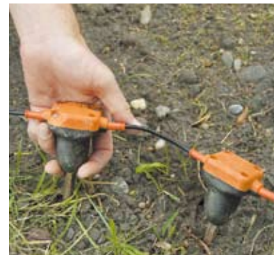
Die sensiblen Geophone registrieren die reflektierten Schallwellen an der Oberfläche
